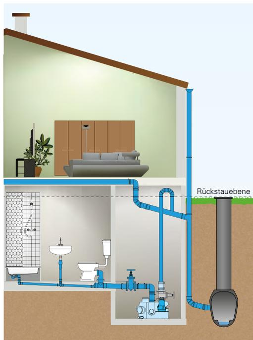
Bild rechts: Hebeanlagen als Rückstausicherung (vereinfachte Darstellung) >>
